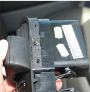
写真の位置に装着し、上部のメタルプレートをベンチレーションフレームの隙間に差し込み折り曲げます。
