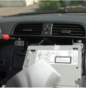
左右のビスを外し、ベンチレーションフレームを外します。
